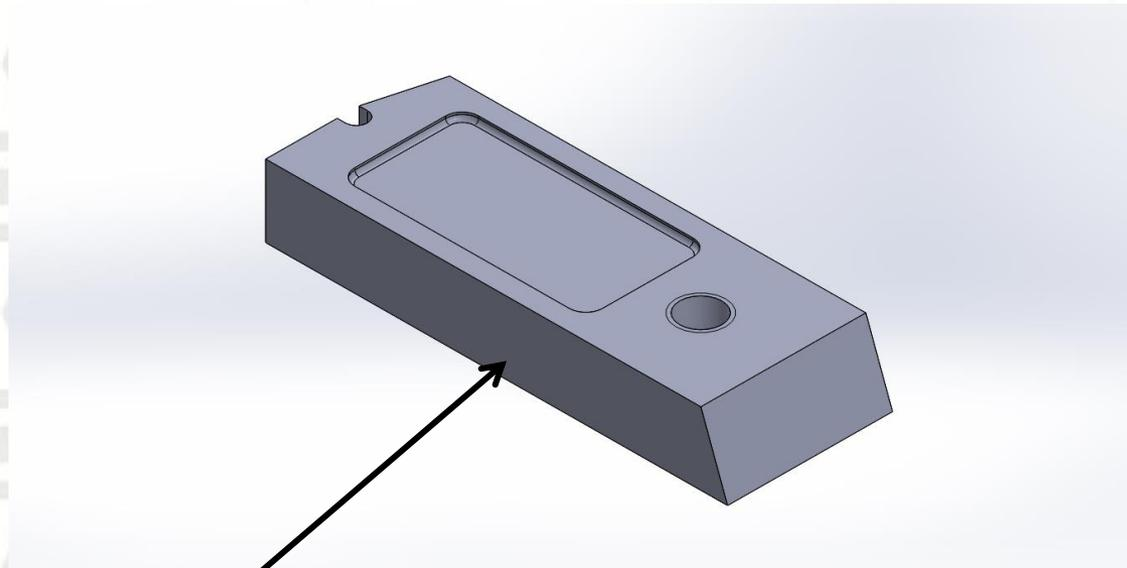
Navalha desenvolvida em Aço ferramenta especial e em Metal Duro com dureza superior a 60 HRc.
